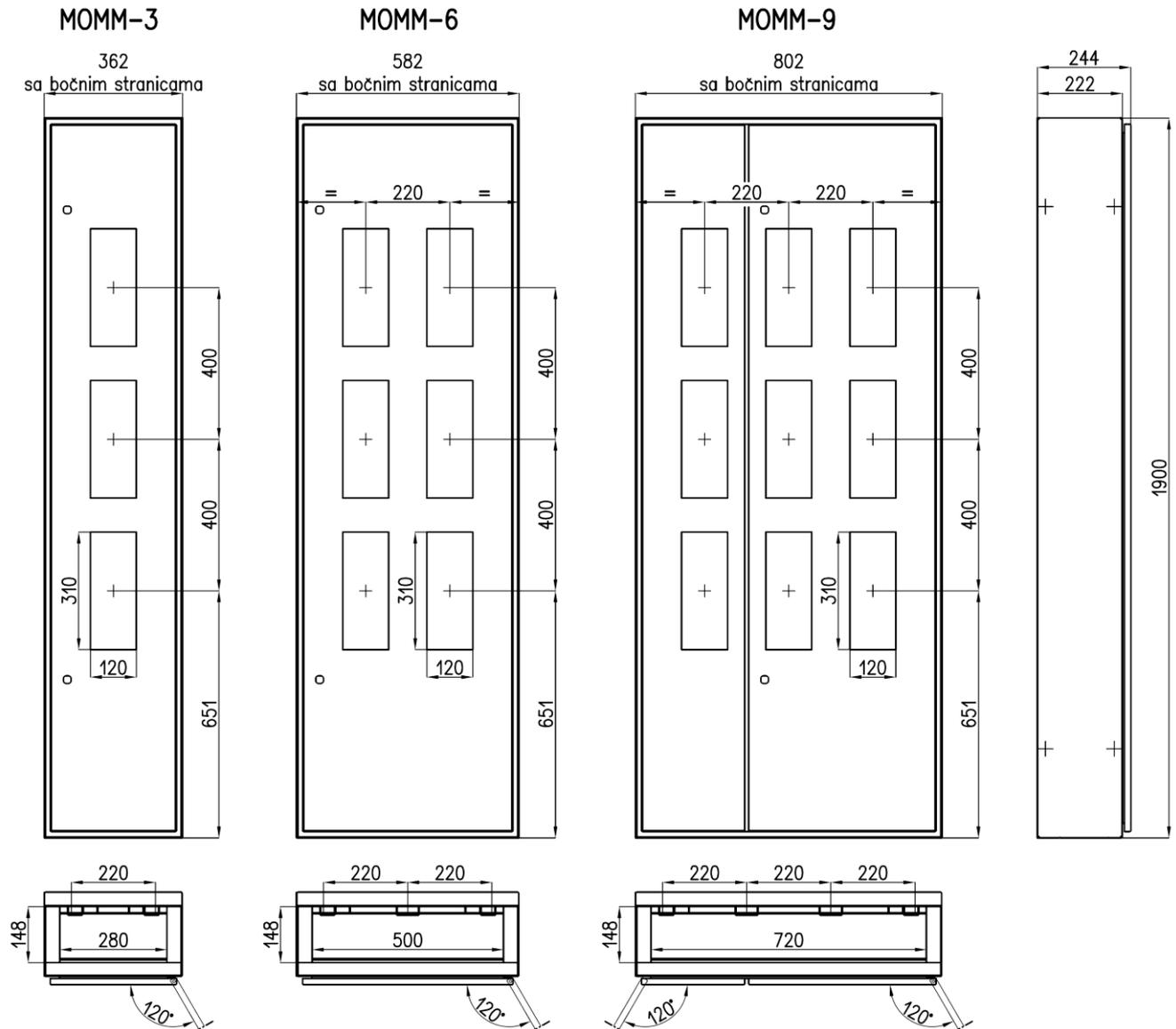
Tipski ugradni ormani iz serije **MOMM** ugrađuju se u zid pojedinačno ili linijski u kombinaciji sa ostalim ormanima iz iste serije, sa zatvaranjem bočnih stranica demontažnim čeličnim panelima.. Sastoje se od kućišta, vrata i bočnih pokrivnih panela.
